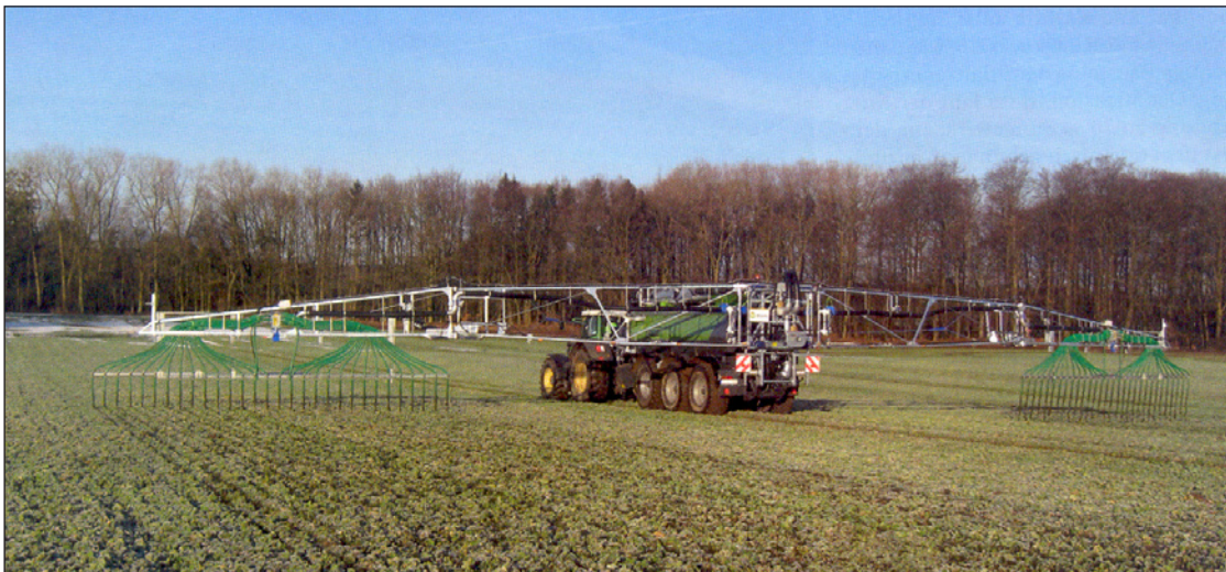
پخش ضایعات تخمیری تولید بیوگاز به کمک پخش کننده شلنگی با بازوهای به طول ۳۶ متر
